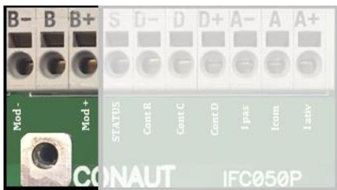
Conexão da saída RS485 Modbus RTU
