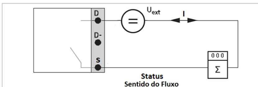
Figura 4-16: Sentido de Fluxo / saída passiva P<sub>p</sub>
