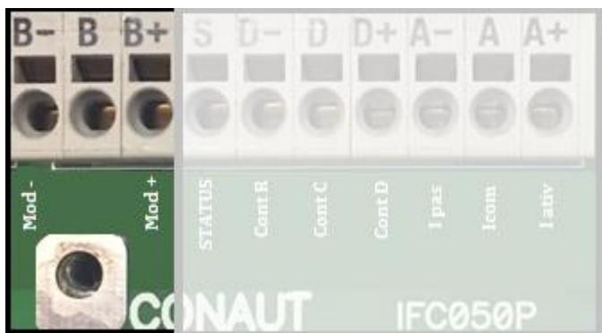
Conexão da saída RS485 Modbus RTU
