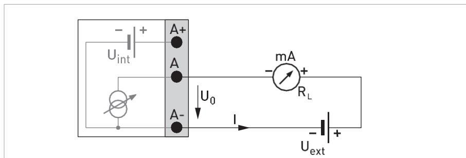
A Figura 4-14: saída de corrente I passiva<sub>p</sub>
