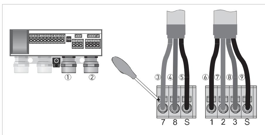
Figura 4-7: Ligação dos cabos correntes de sinal e de campo
