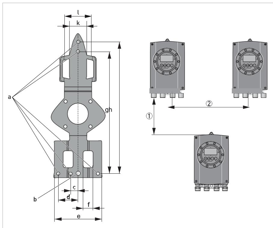
Figura 3-2: Dimensões da placa de montagem e sugestão de distâncias quando vários dispositivos são montados lado a lado
