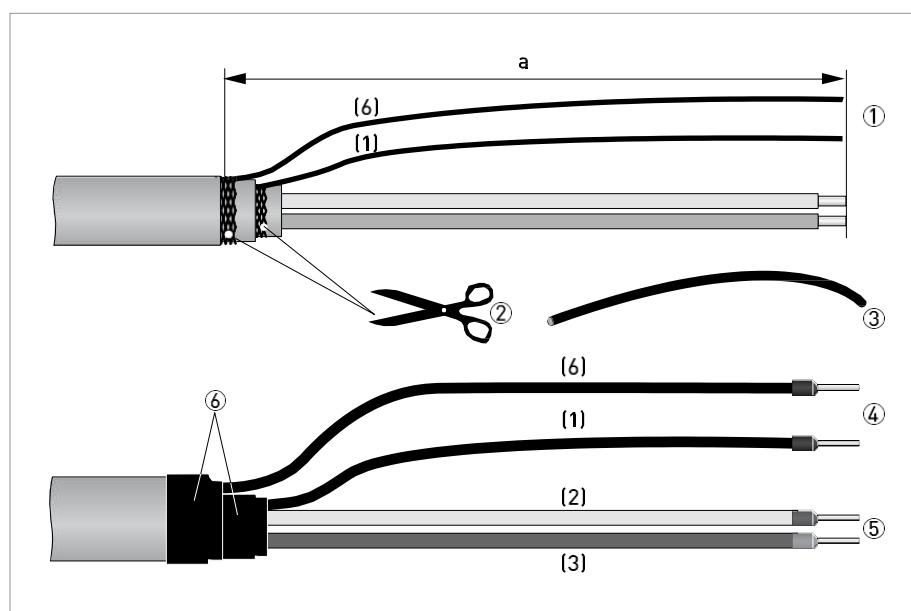
Figura 4-2: Preparação de cabo de sinal A
