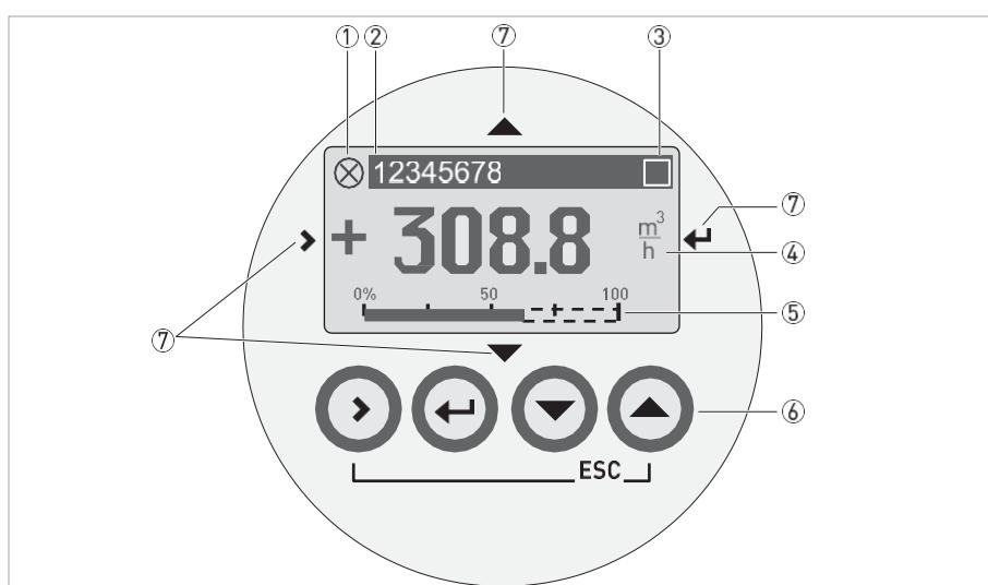
Figura 6-1: visualização e elementos operacionais (Exemplo: indicação de vazão com 2 valores de medição)
