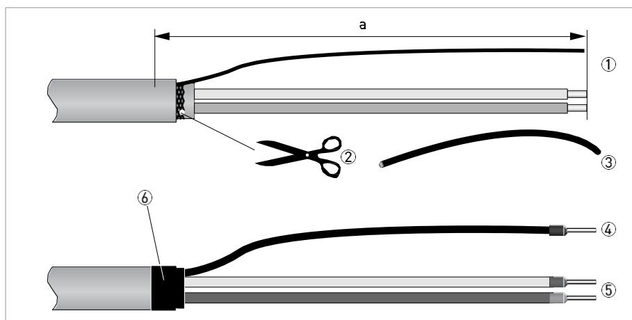
Figura 4-4: cabo de corrente de campo C, a preparação para o conversor de sinal
