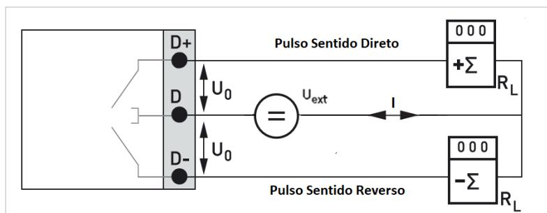
A Figura 4-15: Pulso / Frequência, saída passiva P<sub>p</sub>
