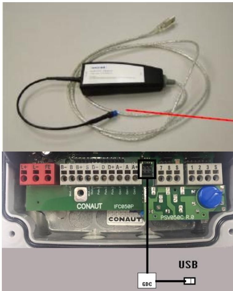
Conexão ao Terminal GDC do IFC050P
