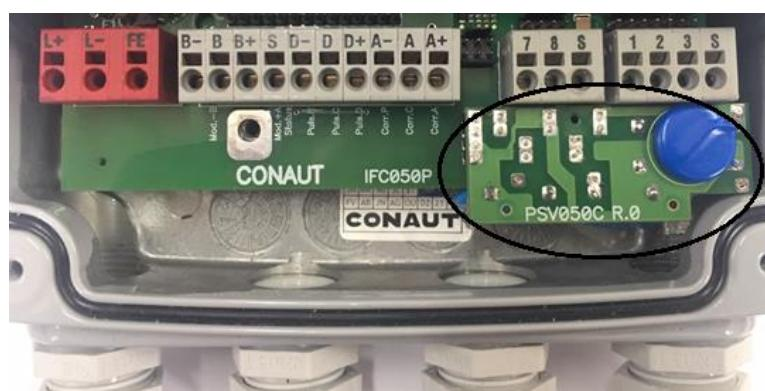
O protetor adicional de Surtos PSV050C pode ser facilmente removido e substituído se necessário.
