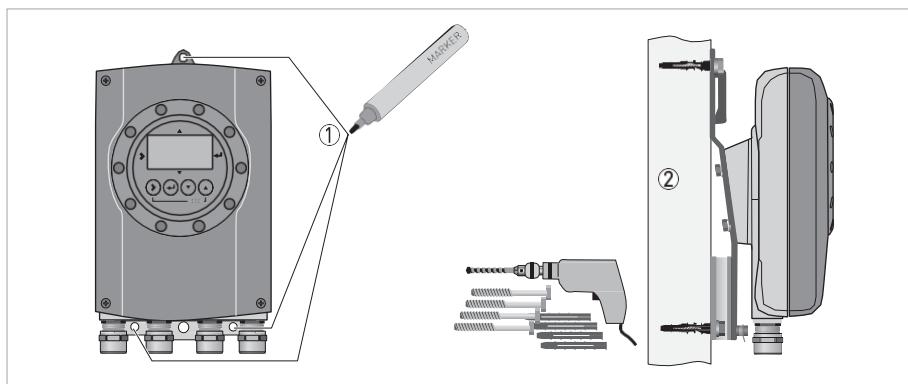
Figura 3-1: fixação da caixa
