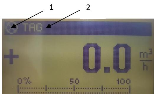
Display 1 – Vazão e Saída de Corrente
