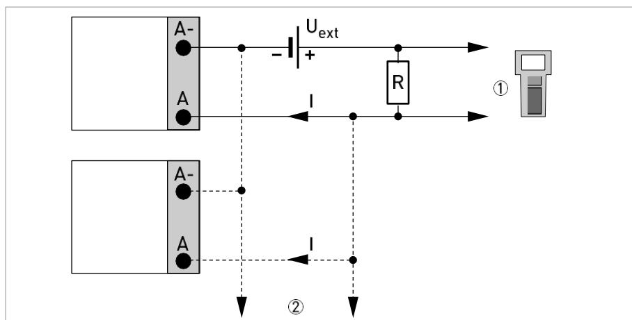
A Figura 4-19: HART® conexão passiva ( $I_p$ )
