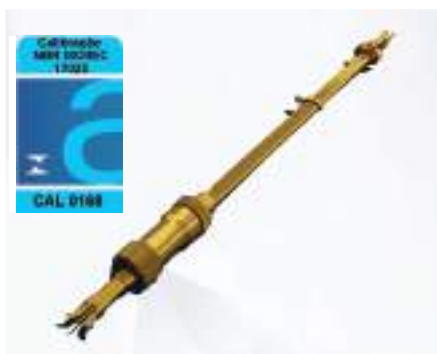
Calibração acreditada de tubo de pitot com água
