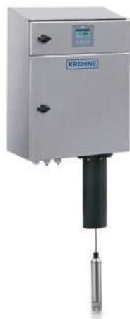
Sistema de medição de manta de lodo: Sistema de medição óptico; sistema de limpeza integrado, medição de perfil de sedimentação.
