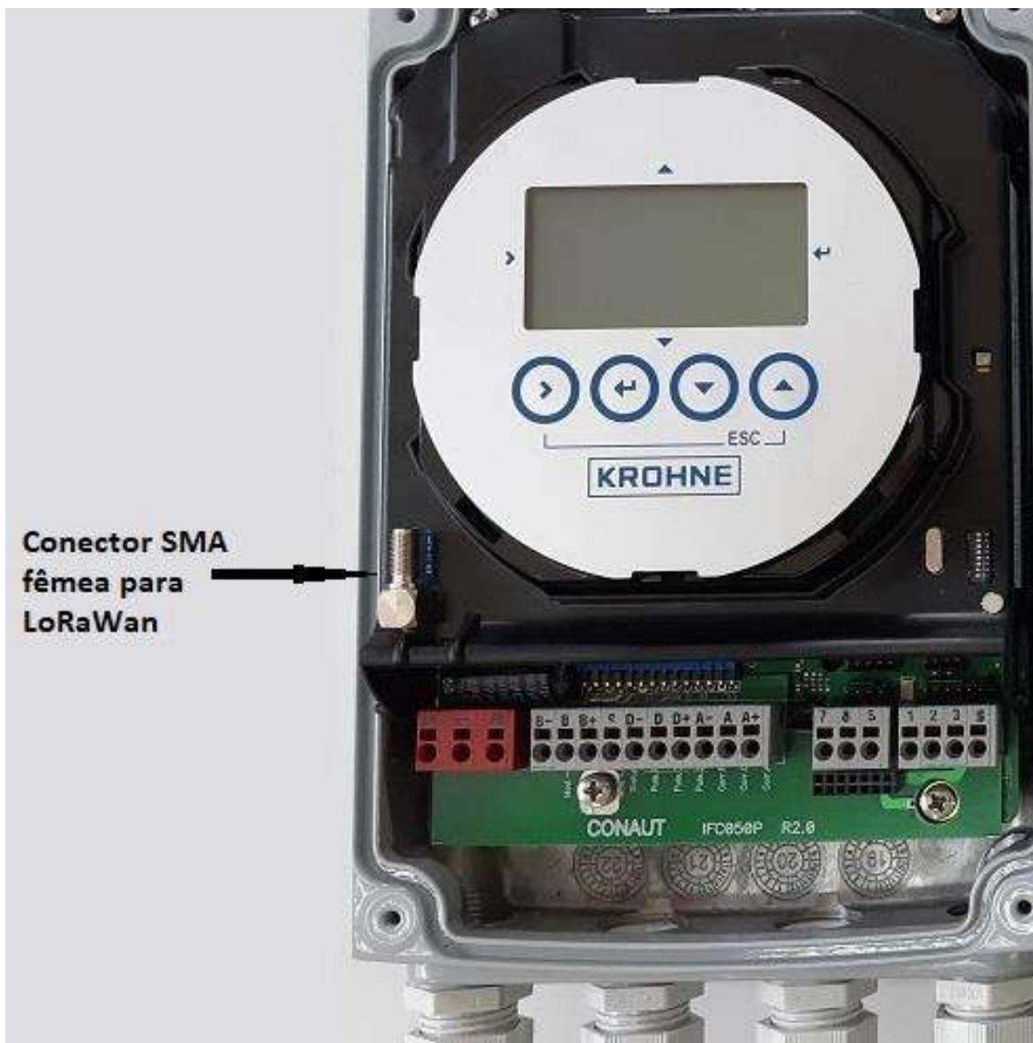
O módulo LoRaWAN utilizado na IFC050P é um transceiver com tecnologia LoRa de baixo consumo e longo alcance. Este módulo integra o protocolo LoRaWAN 1.0.3 e opera nas classes A ou C.
