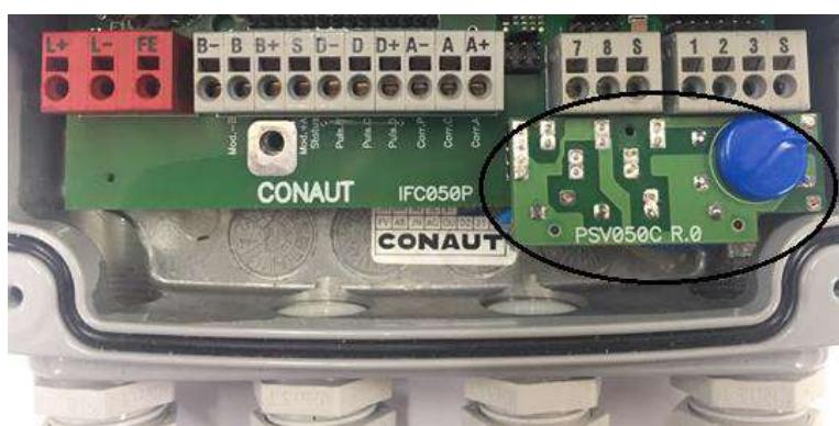
O protetor adicional de Surtos PSV050C pode ser facilmente removido e substituído se necessário.
