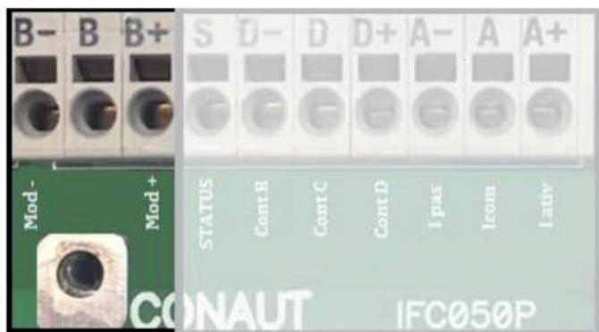
Conexão da saída RS485 Modbus RTU
