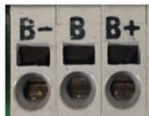
B- = Sinal Negativo. A ser conectado no pino 3(B) do conector DB9
